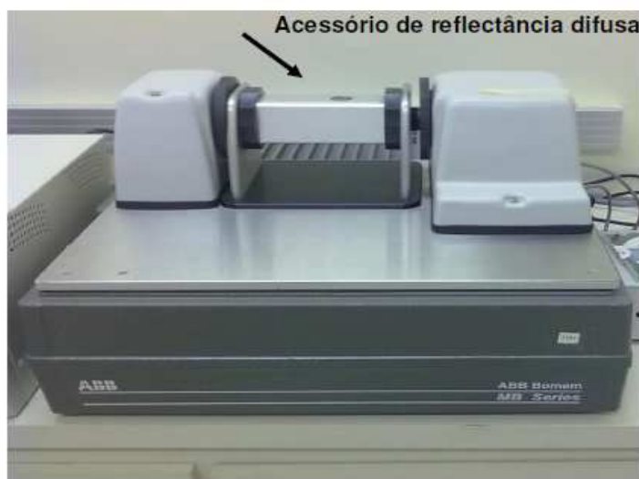
Figura 2: Espectrofotômetro no Infravermelho Próximo com Transformada de Fourier (Bomem) de modelo MB 160 (UFRN, Natal, Brasil).
